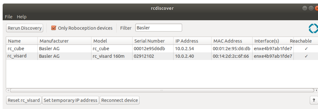
Abb. 3.1: rcdiscover-gui -Tool zum Aufspüren angeschlossener GigE Vision®-Geräte
