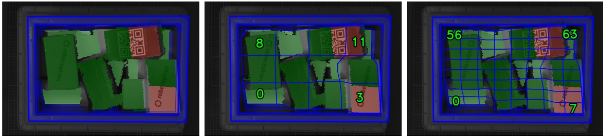
Abb. 6.9: Visualisierungen des Behälterfüllstands: Gesamtfüllstand ohne Raster (links), 4x3 Raster (Mitte), 8x8 Raster (rechts). Der Inhalt wird mit einem Farbverlauf von weiß (auf dem Boden) nach dunkelgrün dargestellt. Die überfüllten Bereiche sind rot dargestellt. Die Nummern stellen die Zell-IDs dar.
